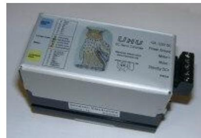
BEAST. Es importante desactivar la señal de reducción de corriente porque utiliza los mismos Pins que la entrada de la parada de emergencia del controlador UHU. Asegúrese también de que la salida de error de los UHU esté configurada como normalmente cerrada (véase el manual de instalación de UHU, sección 5.1). Y si quiere mezclar controladores UHU con controladores BEAST, y la reducción de corriente automática es necesario, corte la señal del parada de emergencia (pin número 1) del UHU.
